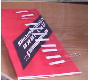
2.5. *Изготовление и наклейка контактов.* Усики датчиков и концы проводов от разъёмов СИИТ припаиваются к контактам. Контакты
