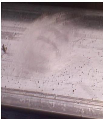
3) Поверхность протирается ватой вымоченной в ацетоне для удаления загрязнения;
