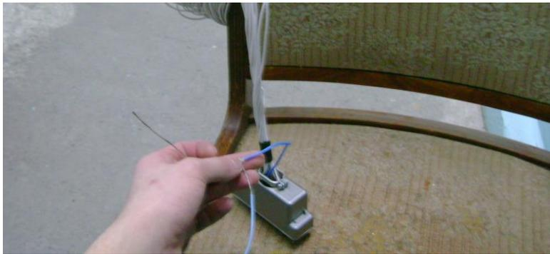
приматывается ещё 11 проводов с уже залуженными концами. Место примотки также залуживается, а после этого обматывается изоляционной лентой.
