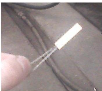
Наклейка: 1) Клеем намазывается датчик и поверхность, на которую этот датчик будет наклеен;
